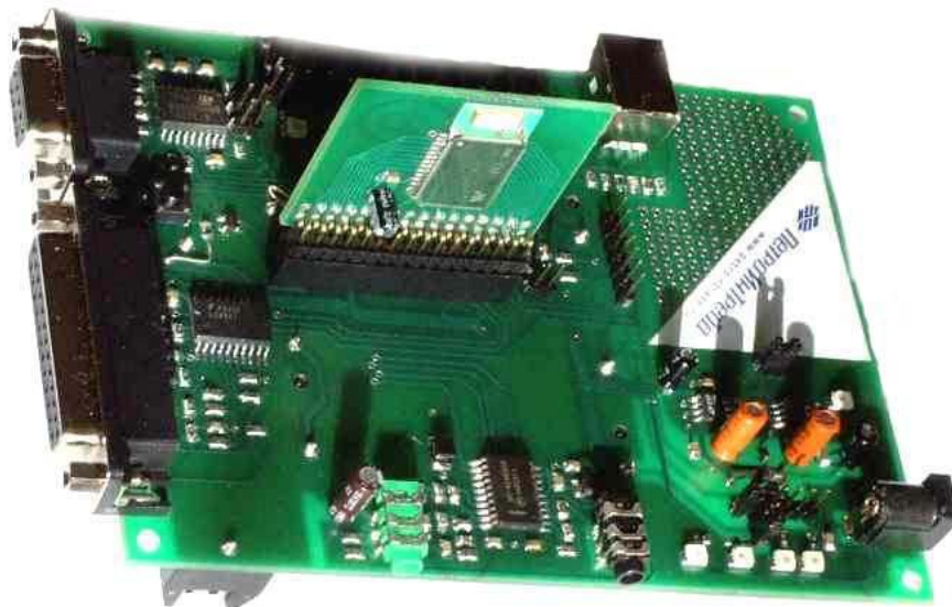
Рис . 9 Отладочная плата на базе Bluetooth модуля CSR WML-C20N
